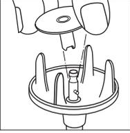
Sett arbeidsdelen loddrett på akselen slik at drivakslingen passer nøyaktig inn i skåret på drivakselen. Fjerning av arbeidsdelen foregår gjennom enkel uttrekking.
