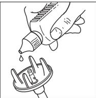
bamix® pysyy kauemmin kunnossa, jos öljyätte sen parin kuukauden väliajoin. Käyttäkää tarkoitukseen hapotonta öljyä, (esimerkiksi vaseliiniöljyä, jota voi ostaa apteekista). Pitäkää bamixista kiinni niin, että suojus on ylöspäin, tiputtakaa 2 – 3 tippaa öljyä käyttöakseliin ja käynnistäkö laite 2 – 3 minuutiksi. Puhdistakaa laite sen jälkeen kuumassa vedessä.
