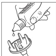
Bamix'en holder længere hvis den får olie hver anden måned. Der skal bruges syrefri olie (f.eks. vaselineolie som kan købes på apoteket). Hold bamix'en med bunden i vejret og tilføj akslen 2-3 dråber olie, hvorefter apparatet tændes i 2-3 minutter. Herefter rengøres apparatet i varmt vand.
