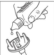
De bamix<sup>®</sup> blijft langer «fit» als u hem om de paar maanden met olie smeert. Gebruik daarvoor zuurvrije olie (bijv. vaselineolie die in de apotheek verkrijgbaar is). Houd de bamix<sup>®</sup> met de beschermkap naar boven, doe 2 à 3 druppels olie op de aandrijf-as en schakel het apparaat ca. 2 à 3 minuten lang in. Reinig het apparaat daarna in heet water.
