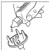
Smörj Bamix-apparaten regelbundet så håller den längre. Använd olja utan syra (tex. vaselinolja, som kan köpas på apotek). Håll bamix<sup>®</sup>-apparaten upp och ner, ge 2 – 3 droppar olja på drivaxelen och kör apparaten ca 2 – 3 min. Rengör sedan apparaten i hett vatten.
